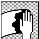
Entfernen Sie vor dem Auftragen von Autosurfacers UV jegliche Oberflächenverunreinigung unter Verwendung entsprechender Oberflächenreiniger.
