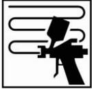
Eine Schicht komplett über die geschliffene Fläche auftragen. Anschließend eine zweite Schicht innerhalb der vorangegangenen Schicht auftragen.
