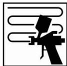
Einen mittleren geschlossenen Spritzgang auftragen, gefolgt von einer Ablüfzeit von 3-5 Minuten bei 20°C. Anschließend eine volle Schicht auftragen und vor der Ofentrocknung eine Ablüfzeit von 3-5 Minuten bei 20°C gewähren.
