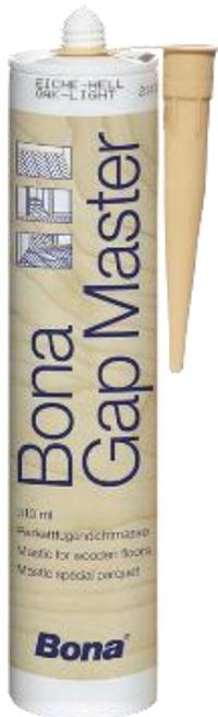
Bona Gap Master ist ein silikonfreie, acrylbasierte Fugendichtmasse zum Verschließen von Fugen zu Sockelleisten und Schwellen in Verbindung mit Holzböden. Die Fugendichtmasse ist in 14 verschiedenen Farben erhältlich und kann nach dem Trocknen mit allen Bona-Lacksystemen überversiegelt werden. Das Material ist dauerelastisch (15 % maximale Gebrauchsdehnung), lösmittelfrei und geruchsneutral.
