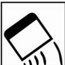
Tragen Sie dünne Schichten auf mit max. 1000 µm. Nachfolgende Schichten können nach 10-30 Sekunden Aushärtung\* aufgetragen werden. Überschreiten Sie nicht das Maximum von 5 Schichten (mit UV-Belichtung zwischen den Schichten wie beschrieben)
