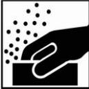
Schleifen Sie die Oberfläche vor dem Auftragen der UV-Spachtelmasse mit mindestens der Körnung P220-P400
