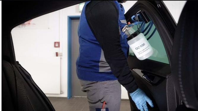
Der Absperrhahn an der Druckluftquelle muss vor dem Anschließen des Verneblers geschlossen sein, um ein unkontrolliertes Freisetzen des Desinfektionsmittels zu verhindern!
